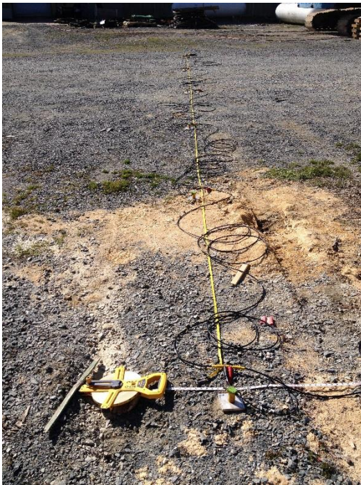
c.) Array for MASW
