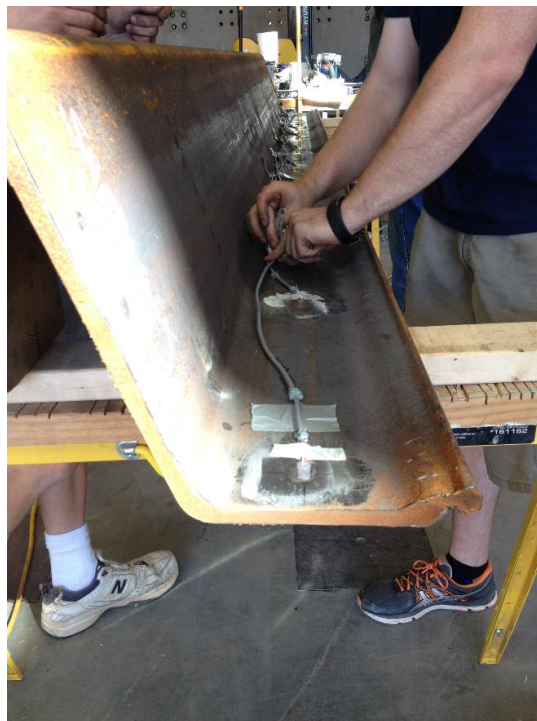
b.) Instrumenting sheet piles
