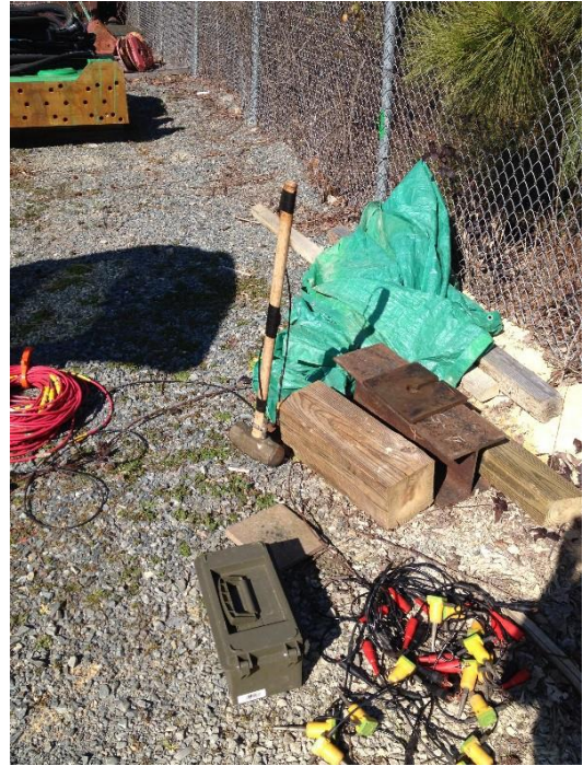
b.) MASW seismic source
