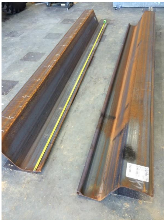
a.) Test sheet piles
